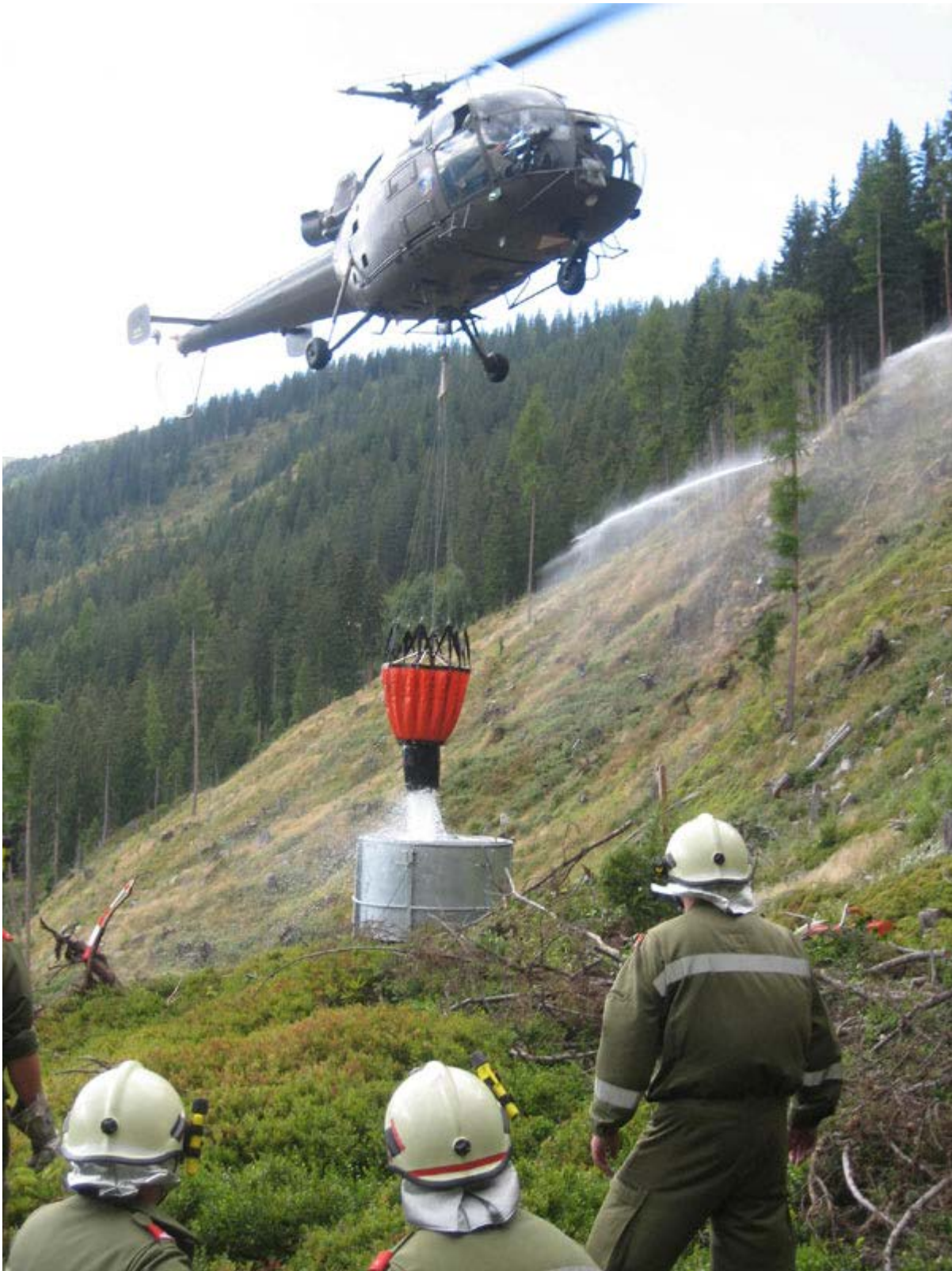
Wassertransport mittels Bambi-Bucket
