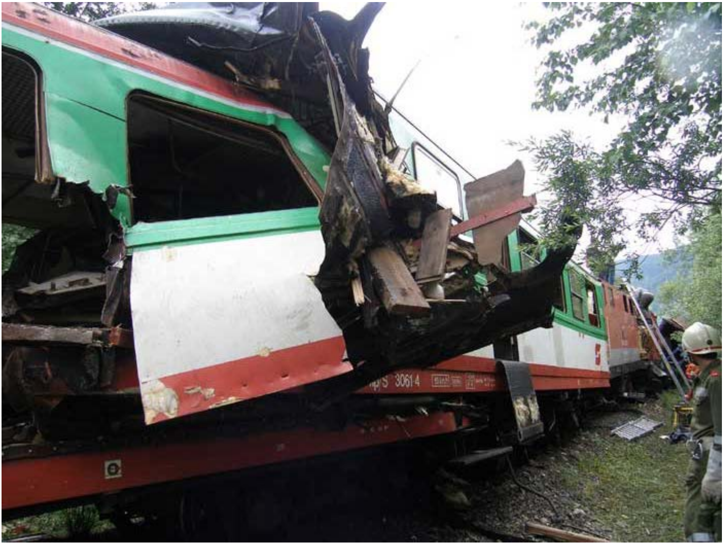
Die 2 ineinandergeschobenen Waggons
